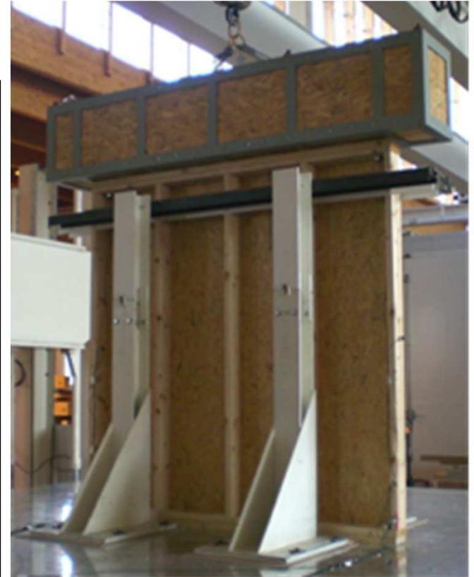
(\*)  $PGA_{\text{non effondrement, test}}$  : pic d'accélération au sol pour que le déplacement relatif en haut du mur corresponde à la limite de non effondrement
